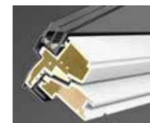
**7** La VELUX Thermo-Technology™ offre nelle finestre in poliuretano un'anima in legno termotrattata e di conseguenza ad alto isolamento (HT). Nelle finestre di legno è composta da un materiale isolante speciale EPS HT 400.
