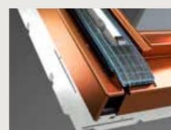
I lati interni delle lamiere di copertura dell'anta sono rivestiti di uno spesso nastro in schiuma. Questo impedisce lo spostamento del ghiaccio e riduce i rumori della pioggia. Inoltre le estremità ottimizzate dell'intelaiatura in vetro minimizzano la superficie di resistenza.
