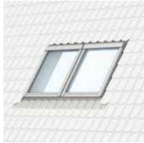
I raccordi prefabbricati gemellati vengono montati in due finestre per tetti di ugual misura e affiancate, a una distanza ridotta del telaio di 18 mm. Insieme ai raccordi prefabbricati gemellati (EBW, EBL) devono essere montati puntoni ausiliari (EBY). I puntoni ausiliari vengono inseriti nella scanalatura della finestra per tetti.
